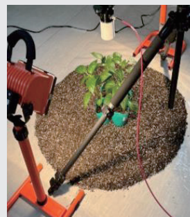
ハイパースペクトルカメラによる分光反射測定
