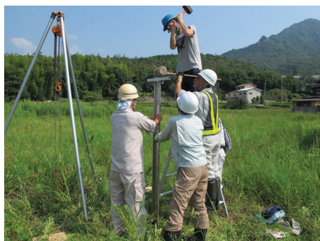
ジオスライサーを用いた土層サンプリングによって地盤災害の履歴を調べる
