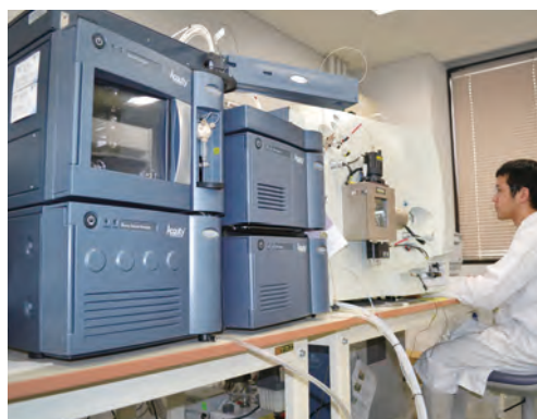
センターの常置管理機器であるベンチトップ直交加速型飛行時間(oa-TOF)質量分析装置(UPLC® / TOF-MS)による有機化合物の精密質量分析
