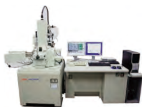
サーマル電界放出形走査電子顕微鏡 [日本電子株式会社 JSM-7600F]
