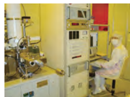
電子線描画装置 (50kV) (最小線幅10nm)
