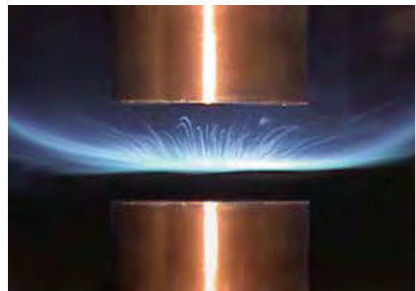
噴霧燃焼の機構解明のため対向する流れの中に形成した液体燃料噴霧火炎の様子
