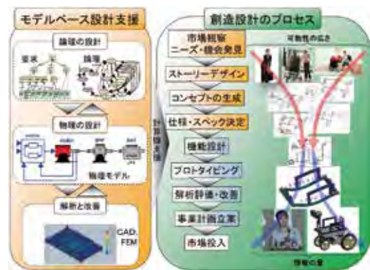
創造設計のプロセスとその具体例、および計算機支援の手法の概要。ニーズと機会の特定から、コンセプト開発、プロトタイプングまでを支援する一連の手法。
