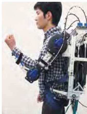
空気圧駆動の人工筋肉を動力源として用いるアシストスーツ。人間の動作に沿ったアシスト実現のため関節角加速度の推定値を用いて制御を行う。
