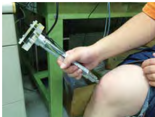
提案する超音波診断装置を用いて膝関節の関節疾患を評価する様子
