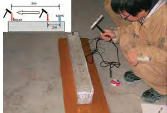
劣化を与えたコンクリートはりに対するインパクトハンマーによる打音実験 (センサーで収集した反射波の周期・振動数のサンプリング解析)
