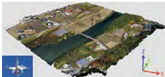
ドローンで測量された3次元点群(佐波川)。 20分足らずの飛行で撮った写真から、約1億点を測量している。 陸上だけでなく、浅い水の底も測量できる。
