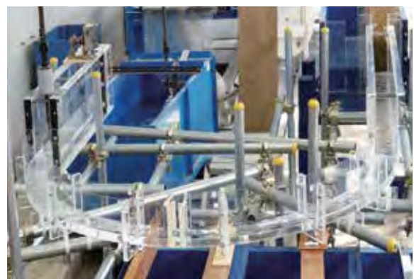
水路中央部の白いテープを貼った部分の壁を取り外すことができます。遠心力の効果によって破壊時の越流流量が直線水路と比較して大きくなります。
