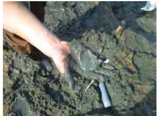
軟弱化が確認された堤防基礎部の石灰改良土層
