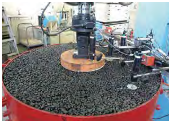
透水性舗装の模型を作成し、浸水させた状態で繰返し載荷することで舗装としての強度を確認する
