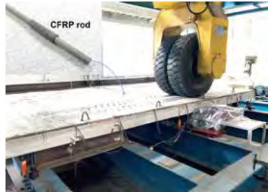
CFRP ロッドを埋め込んで補強したコンクリート床版の輪荷重載荷実験
