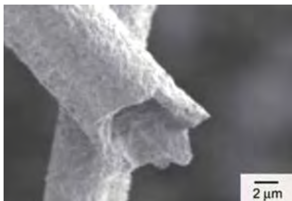
電界紡糸法と無電解めっき法を用いて作製した極細酸化銅チューブ電界紡糸法と無電解めっき法を用いて作製した極細酸化銅チューブ
