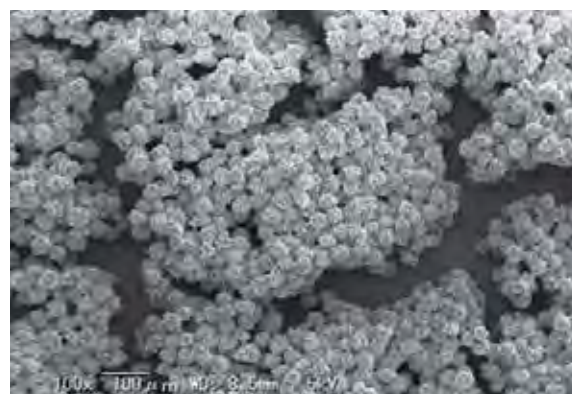
二次核発生を用い効率的に生成した新しい砒素固定結晶。板状結晶で成長速度が速いので球晶の形態を示す。通常の条件と較べ10倍以上の成長速度を示す。
