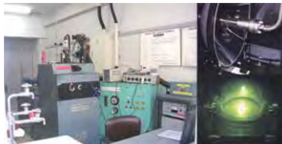
アーキメージ炉。フランス国立太陽エネルギー研究所の超大型太陽炉を再現した疑似太陽炉。キセノンランプを使った光装置で、最高到達温度は約3000°C。
