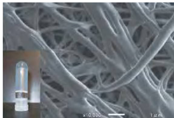
新しい低分子量の有機化合物から創った有機ゲル(左下)と有機ゲルから有機溶媒成分を除去したキセロゲル(乾燥ゲル)の有機ゲル繊維のネットワーク構造
