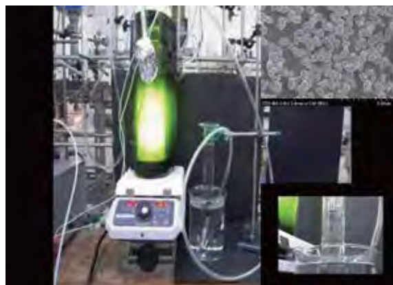
水の分解反応に高い効率を示す修飾酸化ガリウム光触媒とこの光触媒を用いた水の分解反応の様子
