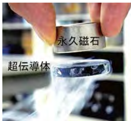
液体窒素(-196℃)で冷却した超伝導体を永久磁石の下に吊り下げた様子(磁束のピン止め現象)
