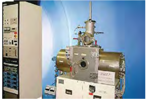
(株)島津製作所との共同研究で製品化したECRスパッタ装置。本装置は、高密度な マイクロ波プラズマを使って高品質な磁性薄膜を基板を加熱せずに作成できる。
