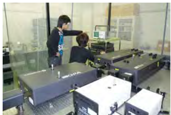
時間分解分光用レーザーシステム。チタンサファイアレーザーとその再生増幅器から構成され、200フェムト秒(1フェムト秒は 10^{-15} 秒)の光パルスが発生する。
