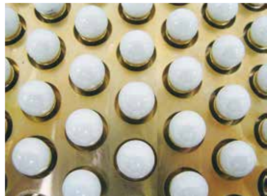
誘電体球(白色)と金属円柱(金色で白色の球の下にある)で構成される負屈折率媒質
