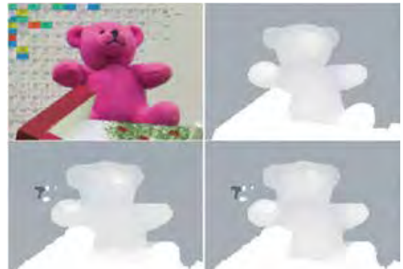
左上図:左眼カメラで撮影した画像、右上図:距離画像の正解、 左下図:従来手法で計算した距離画像、右下図:提案手法で計算した距離画像
