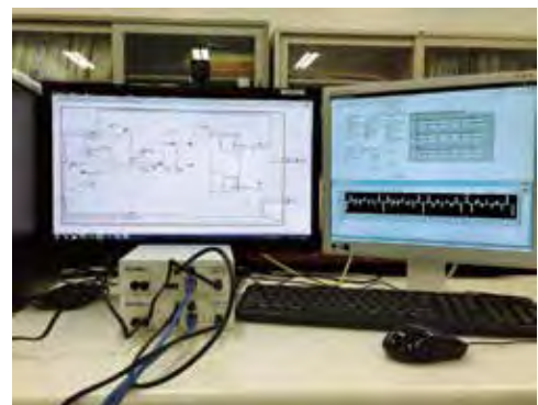
システム開発ソフトウェアにより作成したデジタル回路部とソフトウェア無線機を併せて与えた通信システムの通信実験の様子
