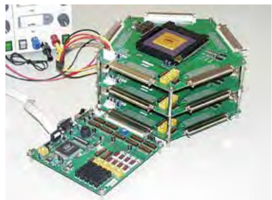
自分自身で計算ユニットの障害状況を判断し、ネットワークを再構成する 3次元積層型VLSIコンピュータの試作システム
