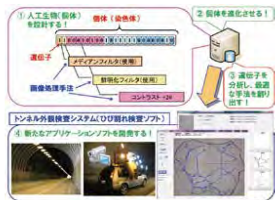
情報知能化技術(遺伝的アルゴリズム、データマイニングなど)を利用したトンネル外観検査のためのアプリケーションソフト開発の流れ
