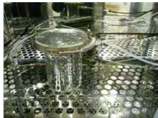
マイクロチャンバーを用いたPVC建材からの準揮発性有機化合物(SVOC) 放散速度測定
