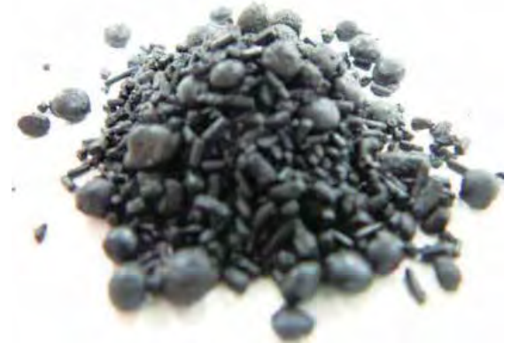
石油精製プロセスから大量に排出される使用済み脱硫触媒
