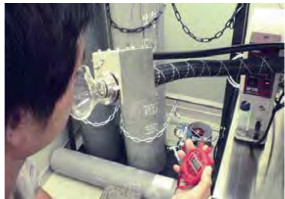
においの原因物質の分析と人の嗅覚によるにおい嗅ぎを同時に行うための装置
