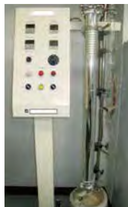
蒸留実験装置-充填塔-
