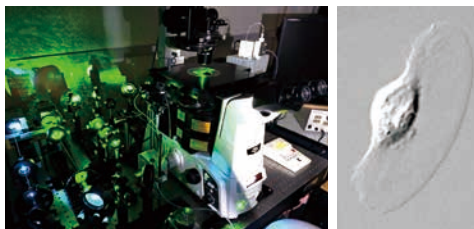
左:全反射照明蛍光顕微鏡。上面に細胞が接着しているカバーガラスの下から斜めにレーザー照明光(青、黄緑)を当て、カバーガラス上面で全反射させる。細胞上部に余計な光が当たらず、細胞底面の分子動態を詳細に観察できる。右:研究材料の一つ魚表皮細胞ケラトサイト。
