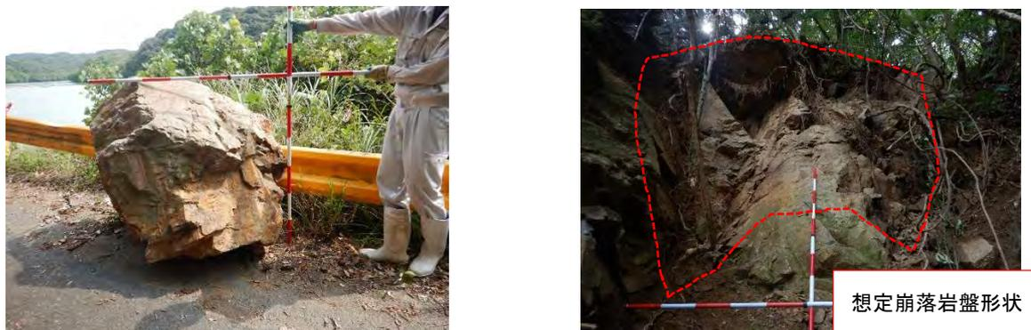
図2 県道上の落石 (左) と露頭の落石跡 (右)
