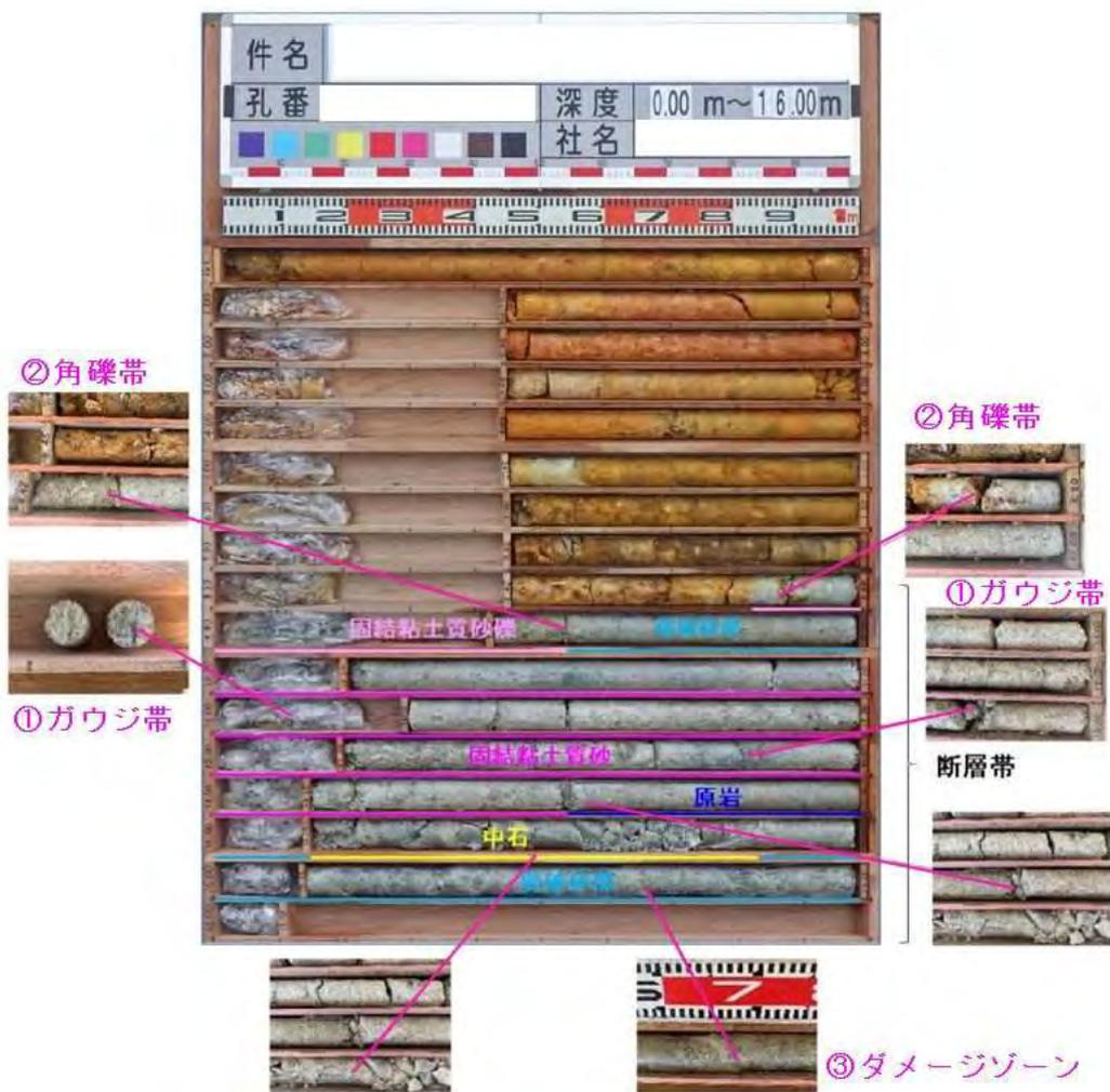
図3. 採取された断層岩のボーリングコア写真 (灰色部分)
