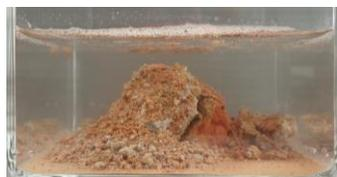
写真 5(a) 試料 C の浸水 30 分後の状態
