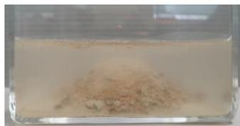
写真 3(a) 試料 A の浸水 30 分後の状態
