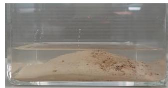
写真 3(b) 試料 A の浸水 2 サイクル後の状態
