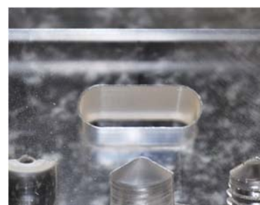
(c) 長穴加工(アクリルのみ) ボルトを挿入してスライドさせることができる
