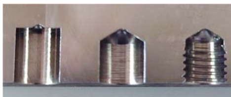
(c) 穴加工断面図 左:ローソクキリ(底面のみ、内径側面はエンドミル) 中:皿キリ 右:ネジ加工
