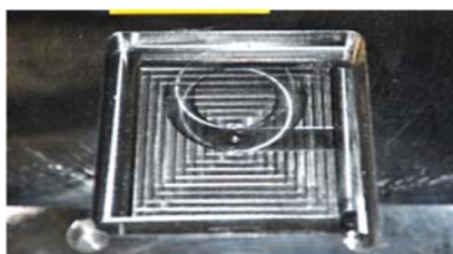
(a) ポケット加工底部の仕上がり 同心状のカッターマークと中心の下穴加工痕が確認できる
