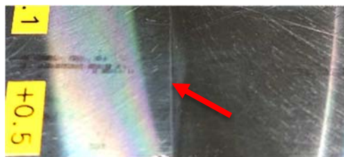
(b) フェイスミルによる平面加工 表面のカッターマークと、図中央付近(赤矢印)に縦方向の継ぎ目があることが確認できる
