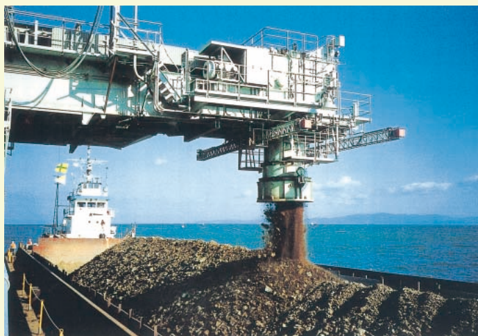
「光センサを用いたバージ積載土量自動計測システム」(埠頭型) (アームの動きに合わせて土面形状データを自動採取し、土量を計測)
