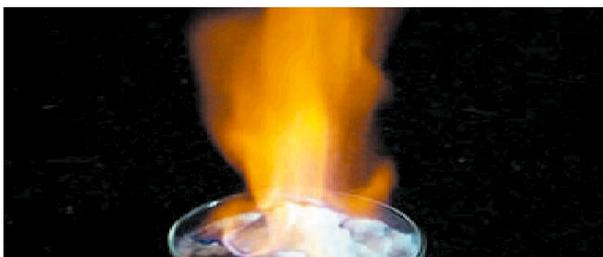
写真-1 メタンハイドレートの燃焼の様子
