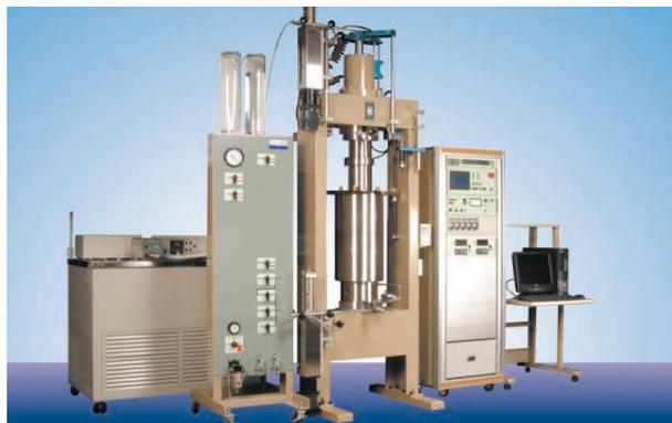
写真-3 メタンハイドレート用三軸試験装置
