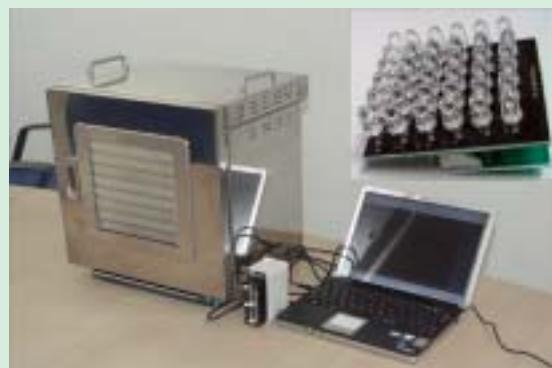
写真3 開発した人工気象器およびその中で使用されているLED（右上）
