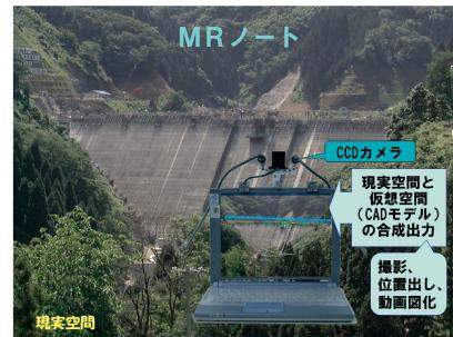
図－5 ノートパソコンで実現したMRシステム（CCDカメラで取得した実画像からPCの位置や傾きを自動認識し、三次元のCADデータを合成する）
