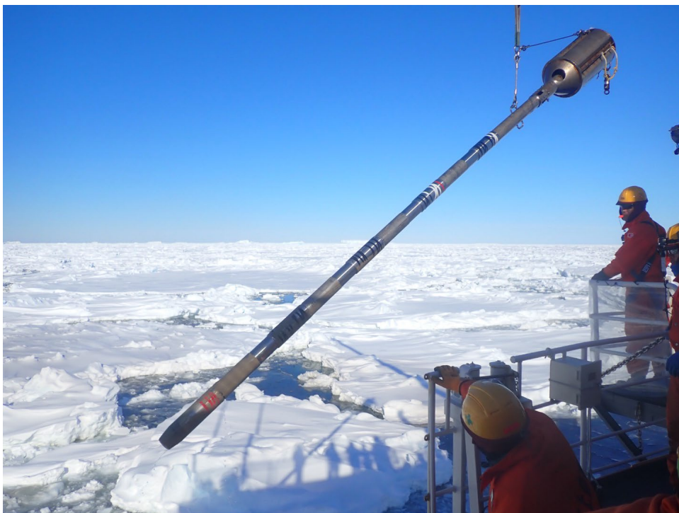
第 61 次南極地域観測隊（2019-2020 年）における、南極観測船「しらせ」からの海底堆積物コア採取の様子。大きな筒型の装置（コアラー）を海底に垂直に突き刺した後に引き上げ、海底堆積物を採取する。南極大陸沿岸での調査動画は以下の URL からダウンロード可能。
