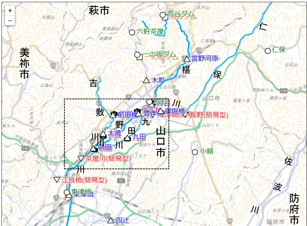
図2 榎野川水系における雨量局(○)、水位局(△)、簡易型水位計(▽)の設置場所 (山口県土木建築部河川課計画調整班(2025)より転載・加筆、破線枠は図1・図3の範囲)
