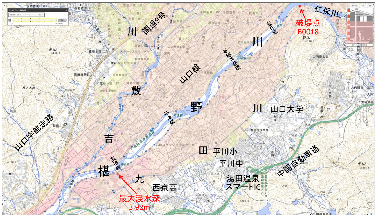
図10 「浸水ナビ」における榎野川の破堤による浸水想定（浸水範囲、浸水深）（「浸水ナビ」（国土交通省国土地理院応用地理部、2025）から転載・加筆）
