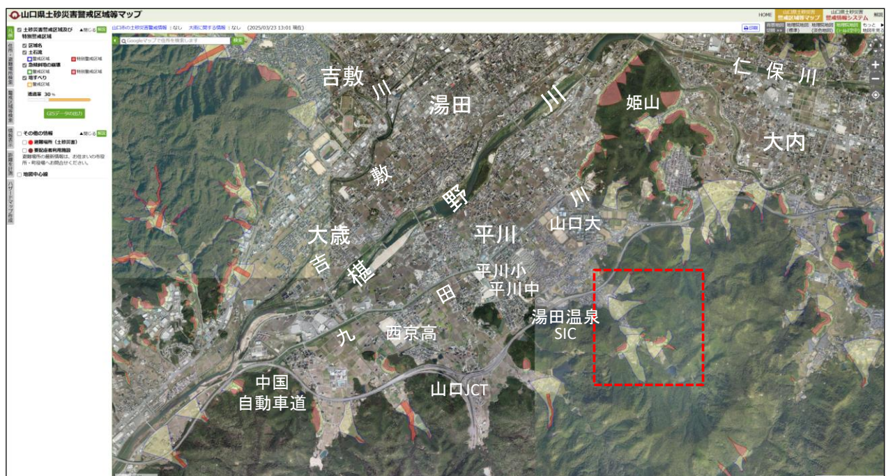
空中写真 2 山口盆地南部の土砂災害警戒区域等マップ (山口県土木建築部砂防課 (2025b) より転載・加筆、赤色破線枠は空中写真 3 の範囲)
